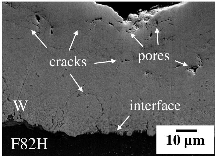
(d) VPS-W cross-section, fractured
