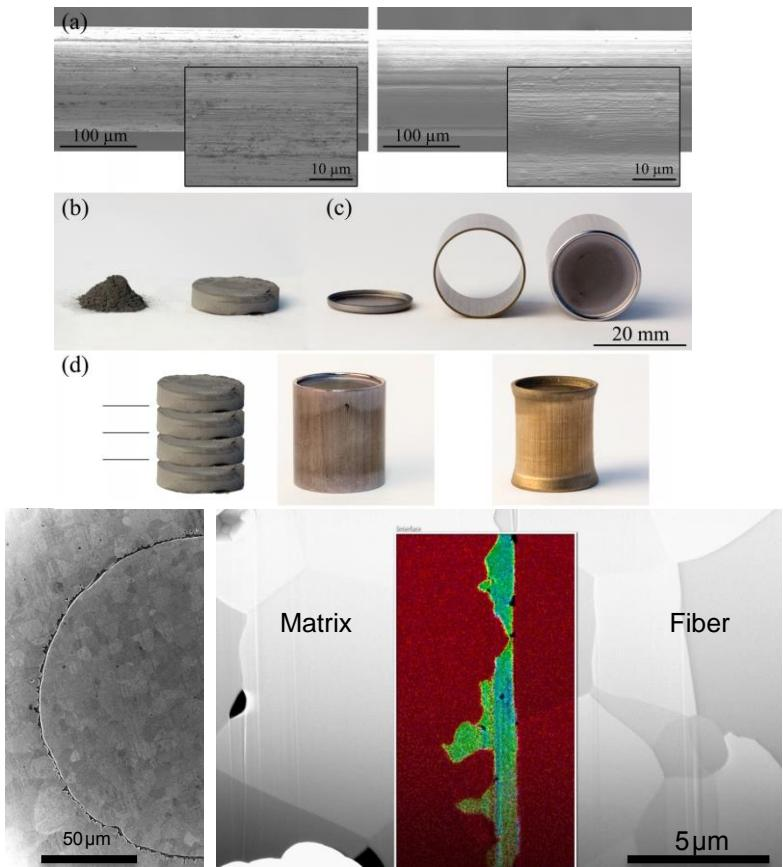
Single Fibre W<sub>f</sub>/W , 150μm fibre , HIP Matrix
